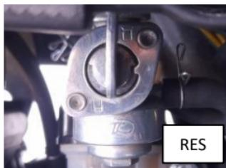
**OFF:** Se interrumpe el suministro de combustible. Coloque el grifo en "OFF" cuando vaya a almacenar el Vehículo o cuando vaya a demostrar el tanque del combustible.
