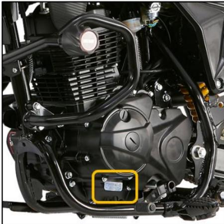
El número del motor se encuentra en la carcasa izquierda del motor en la parte inferior.
